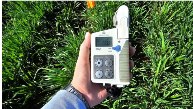
Figura 5. Medidor de clorofila SPAD 502 Plus® modelo 2900P de Minolta.
